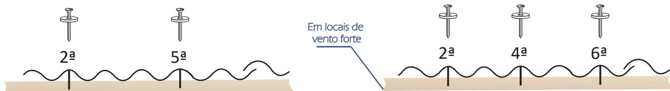
Para recobrimentos transversais de 1 ¼ de onda, a fixação deve ser realizada na 2ª e 5ª crista.
