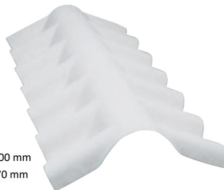
\*FIXAÇÃO: 2 parafusos de 150 mm (para telhados com inclinação entre 10° e 20°; acima de 20° usar parafusos de 110 mm)
