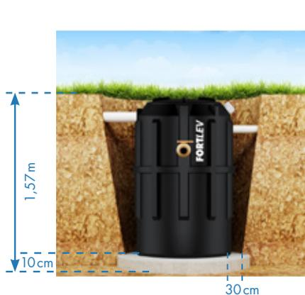
Figura 3 – Instalação sem laje de fechamento.
