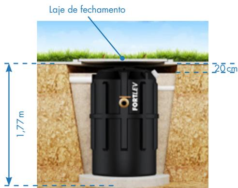
Figura 4 – Instalação com laje de fechamento.
