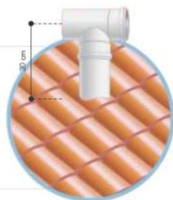
É utilizado um Tê ou peça tipo terminal para impedir a entrada de águas pluviais na tubulação. De toda forma, a tubulação de ventilação deve ser instalada com a cota mínima de 1%, de modo que qualquer líquido que porventura ingressar possa escoar por gravidade para a tubulação de esgoto.
