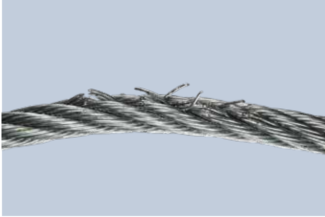
Figura 4: Arames rompidos devido ao desgaste
