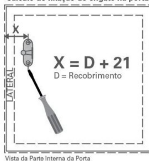
Cálculo de fixação do engate na porta
